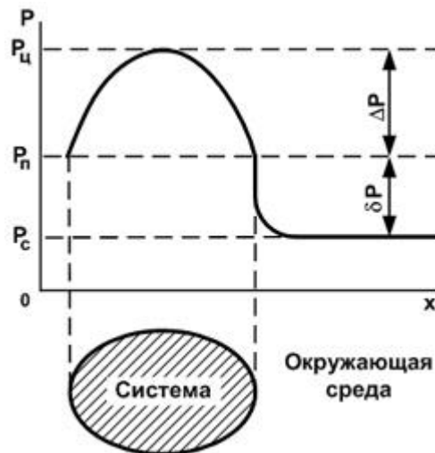
Рис. 5. Схема определения перепада и напора потенциала.
