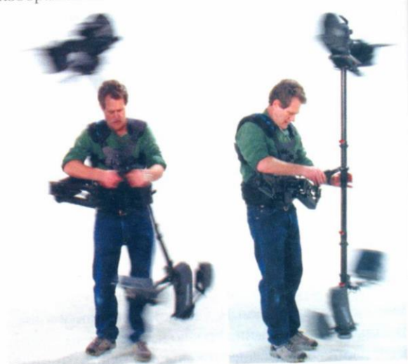
Вследствие инерционности системы вертикальное панорамирование выполнять гораздо тяжелее, чем горизонтальное
