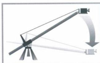
Камера сохраняет направление съемки при подъеме/ опускании стрелы
